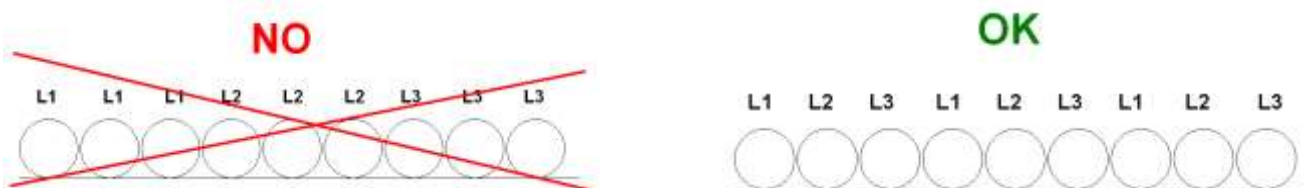
Рис. 17 - прокладка проводов питания большой длины
